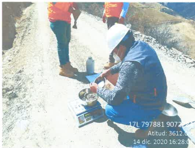
Fig. 12 Prueba de densidad de campo en tramo intervenido (17L 797881E 9072284N) Alt. 3612.00m
