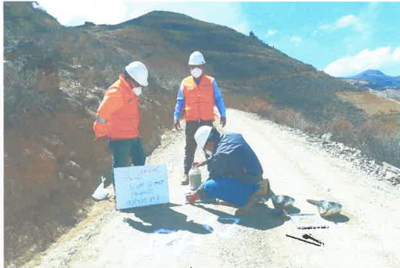
Fig. 11 Prueba de densidad de campo en tramo intervenido (17L 797873E 9072187N) Alt. 3596.00m
