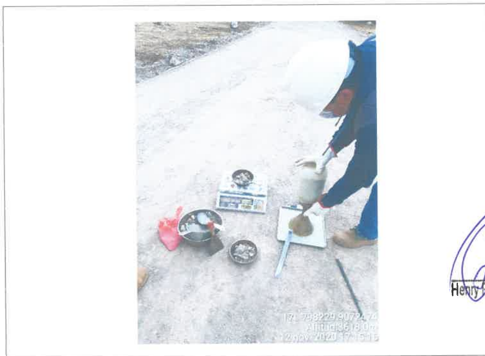
Fig. 10 Prueba de densidad de campo en tramo intervenido (17L 798229E 9072474N) Alt. 3618.00m
