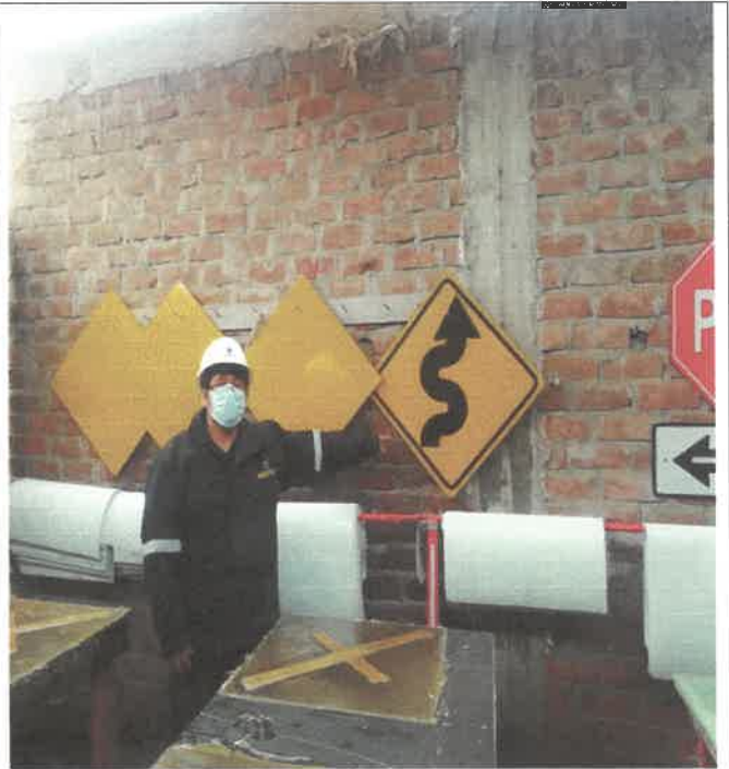
Verificación de la fabricación de las señales preventivas en el almacén de producción, para la colocación de los mismos, en la vía referente al paquete 14, Puchaypampa-Sogobara-Sincaz, Señal preventiva Km 1+600
