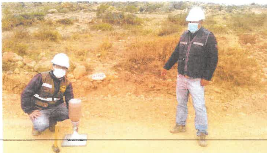
PRUEBA DE DENCIDAD DE CAMPO PROG. 6+400 SOGOBARA – SINCAZ
