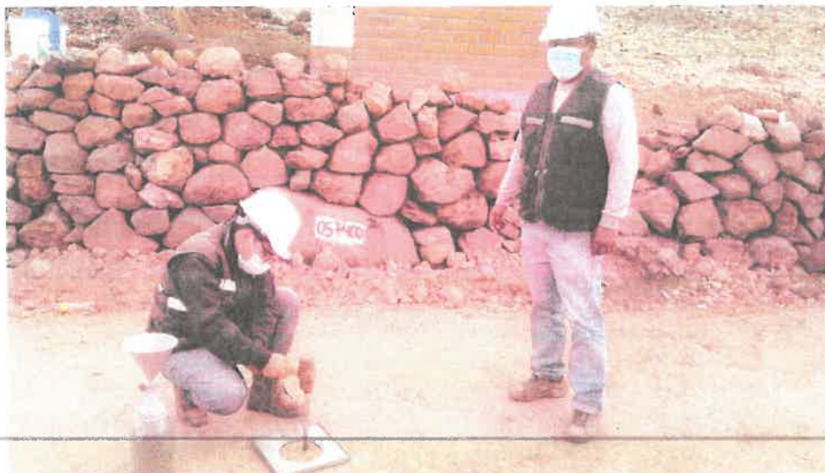
PRUEBA DE DENSIDAD DE CAMPO EN LA PROG. 5+400 FIN DEL TRAMO PUCHAYPAMPA - SOGOBARA
