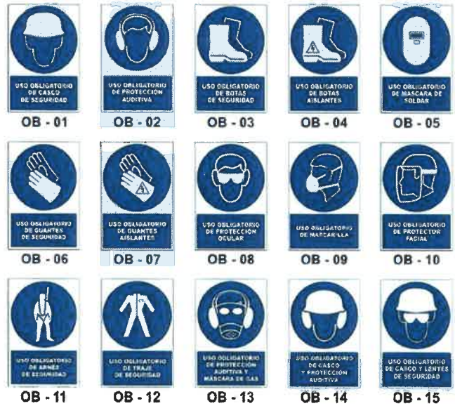
Foto N° 06: Señales obligatorias de uso de EPP's (ENTRADA A SERVICIO)
