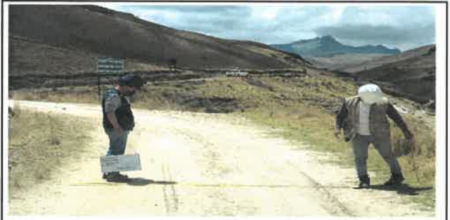
Foto N° Top6: Vista del ancho de la superficie de rodadura en el Km 01+250.
