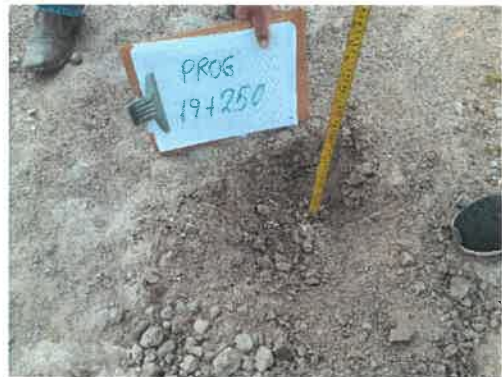
Foto 78: KM 19+250 Midiendo el espesor de afirmado existente (0.17)
