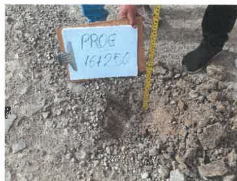
Foto 66: KM 16+250 Midiendo el espesor de afirmado existente (0.12)
