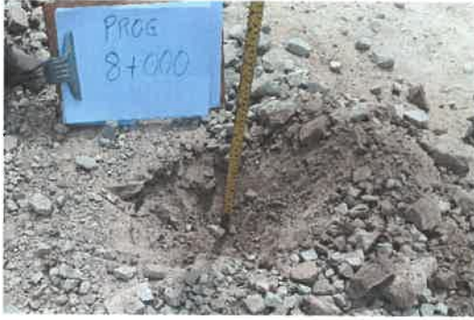
Foto 3: KM 8+000, Midiendo el espesor de afirmado existente (0.13 m.)
