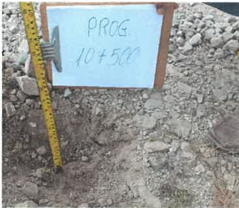
Foto 41: KM 10+000 Midiendo el espesor de afirmado existente (0.05 m.)
