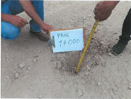
Foto 05: KM 1+000, Midiendo el espesor de afirmado existente (0.09m.)
