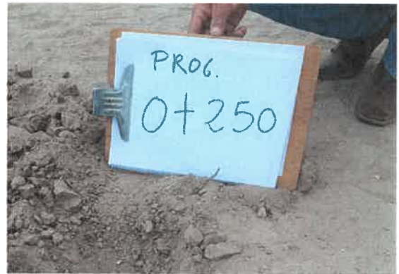
Foto 02: KM 0+250, Midiendo el espesor de afirmado existente (0.10 m.)
