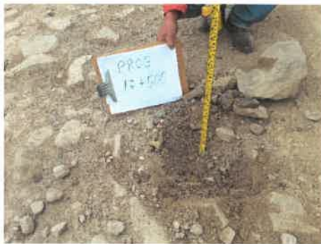
Foto 69: KM 17+000, Midiendo el espesor de afirmado existente (0.12 m.)
