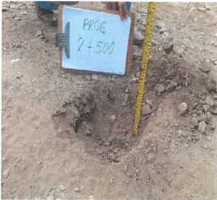
Foto 11: KM 2+500, Midiendo el espesor de afirmado existente (0.12 m.)
