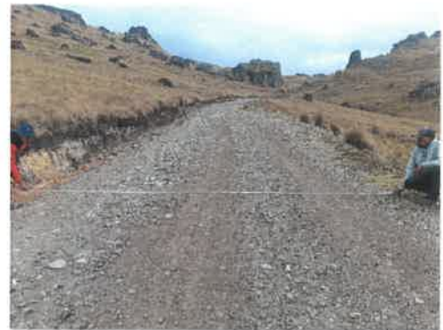
Foto 058: KM 14+000 Vista toma de información en campo, detallando el ancho de plataforma.
