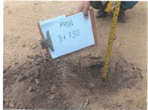
Foto 16: KM 3+750, Midiendo el espesor de afirmado existente (0.10 m.)
