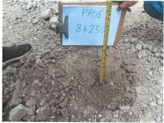
Foto 34: KM 8+250, Midiendo el espesor de afirmado existente (0.15 m.)
