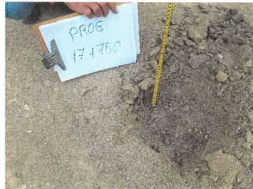
Foto 72: KM 17+750 Midiendo el espesor de afirmado existente (0.12)
