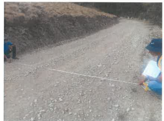
Foto 044: KM 10+500, Vista toma de información en campo, detallando el ancho de plataforma.
