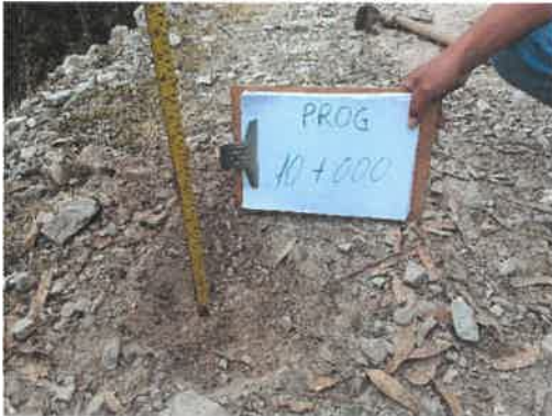
Foto 41: KM 10+000 Midiendo el espesor de afirmado existente (0.05 m.)
