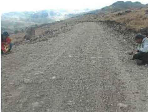
Foto 069: KM 16+750, Vista toma de información en campo, detallando el ancho de plataforma.
