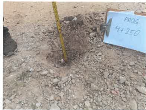
Foto 18: KM 4+250, Midiendo el espesor de afirmado existente (0.13 m.)
