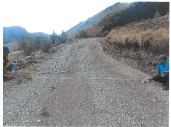
Foto 050: KM 12+000, Vista toma de información en campo, detallando el ancho de plataforma.
