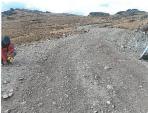
Foto 063: KM 15+250, Vista toma de información en campo, detallando el ancho de plataforma.
