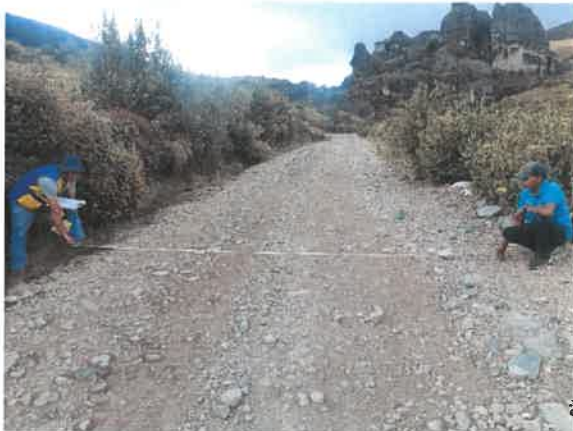
Foto 049: KM 11+750, Vista toma de información en campo, detallando el ancho de plataforma.
