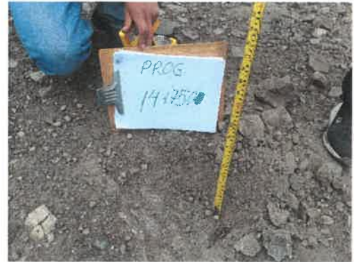
Foto 60: KM 14+750 Midiendo el espesor de afirmado existente (0.12)
