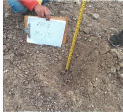
Foto 58: KM 14+250, Midiendo el espesor de afirmado existente (0.15 m.)
