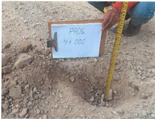
Foto 17: KM 4+000, Midiendo el espesor de afirmado existente (0.10 m.)
