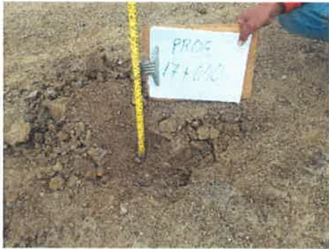
Foto 69: KM 17+000, Midiendo el espesor de afirmado existente (0.12 m.)
