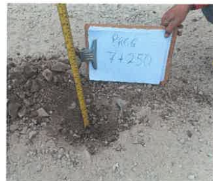
Foto 30: KM 7+250, Midiendo el espesor de afirmado existente (0.10 m.)
