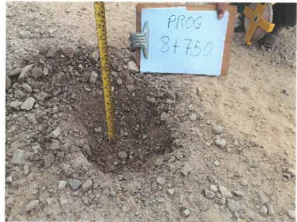
Foto 36: KM 8+750, Midiendo el espesor de afirmado existente (0.10 m.)
