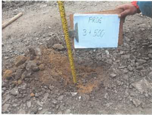
Foto 15: KM 3+500, Midiendo el espesor de afirmado existente (0.05 m.)
